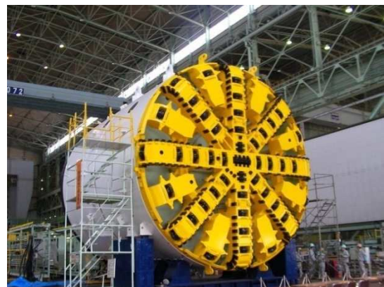
[그림 25] 쉴드TBM 머신
