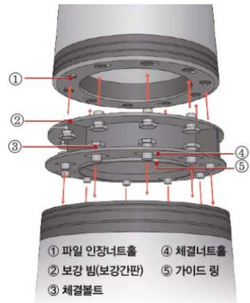
[그림 66] 고강도 콘크리트파일 원리
