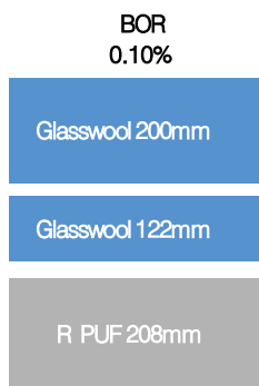
[그림 13] 대우조선해양의 NO 96 L3 타입 LNG선 보냉재
